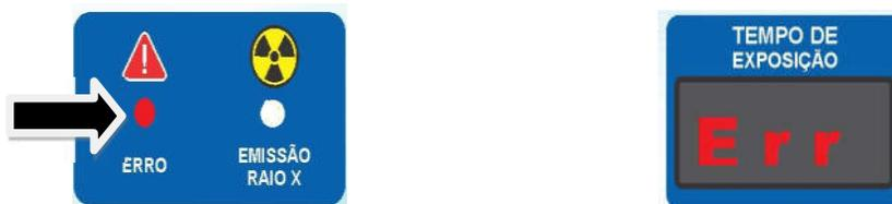
**IMPORTANTE:** se o operador não segurar o botão do disparador até o final do tempo, no painel a luz ERRO ficará vermelha, tocará o alarme e irá resfriar o Aparelho durante 30 segundos.
