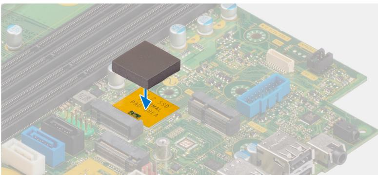
2. Retire o Mylar de proteção na almofada térmica.
