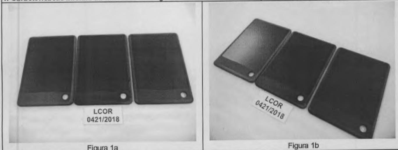
2. Após 48 horas de ensaio: sem alteração visual em relação à condição inicial.
