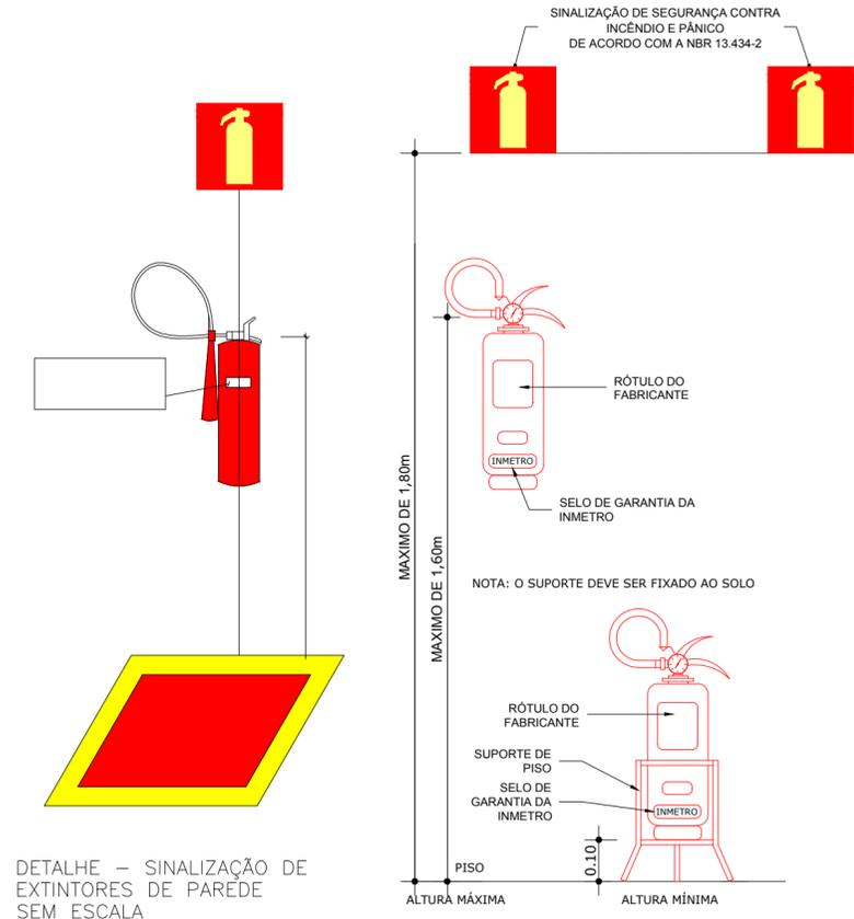
DETALHE - SINALIZAÇÃO DE EXTINTORES DE PAREDE SEM ESCALA
