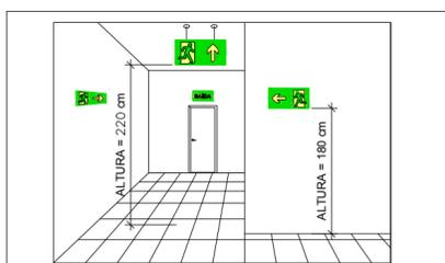
DETALHE FIXAÇÃO DAS PLACAS DE SINALIZAÇÃO DE EMERGÊNCIA
