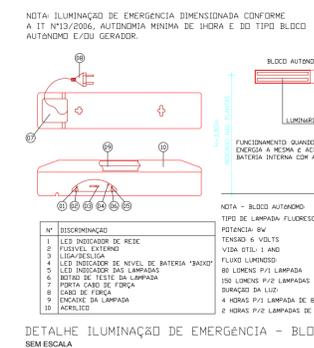
DETALHE ILUMINAÇÃO DE EMERGÊNCIA - BLOCO AUTÔNOMO SEM ESCALA
