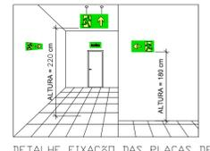
DETALHE FIXAÇÃO DAS PLACAS DE SINALIZAÇÃO DE EMERGÊNCIA SEM ESCALA
