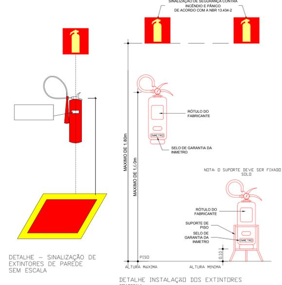
DETALHE - SINALIZAÇÃO DE EXTINTORES DE PAREDE SEM ESCALA
