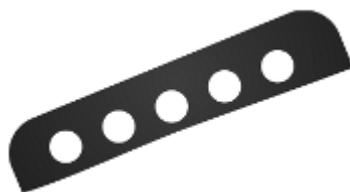
**Ilhós:** peça metálica que é fixada no cabedal por meio de prensagem, na região vista de ilhoses, dando um melhor acabamento facilitando a passagem do atacador (cadarço) pelos furos. Constituído de alumínio da cor natural levando um banho com produto antioxidante, com diâmetro externo da cabeça (aproximada) de 9,5 mm, diâmetro interno de 4,5 mm e altura de 6,2 mm.
