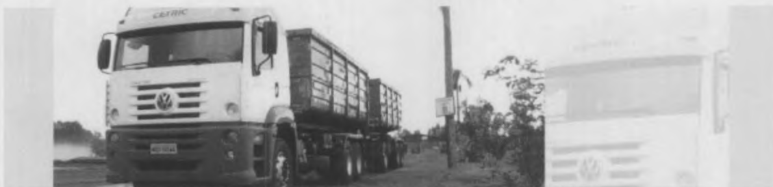
Figura 02 – Caminhão Roll-On/Roll-Off com julieta
