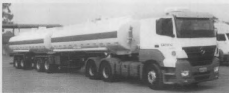
Figura 04 - Caminhão tanque e com bombeamento a vácuo
