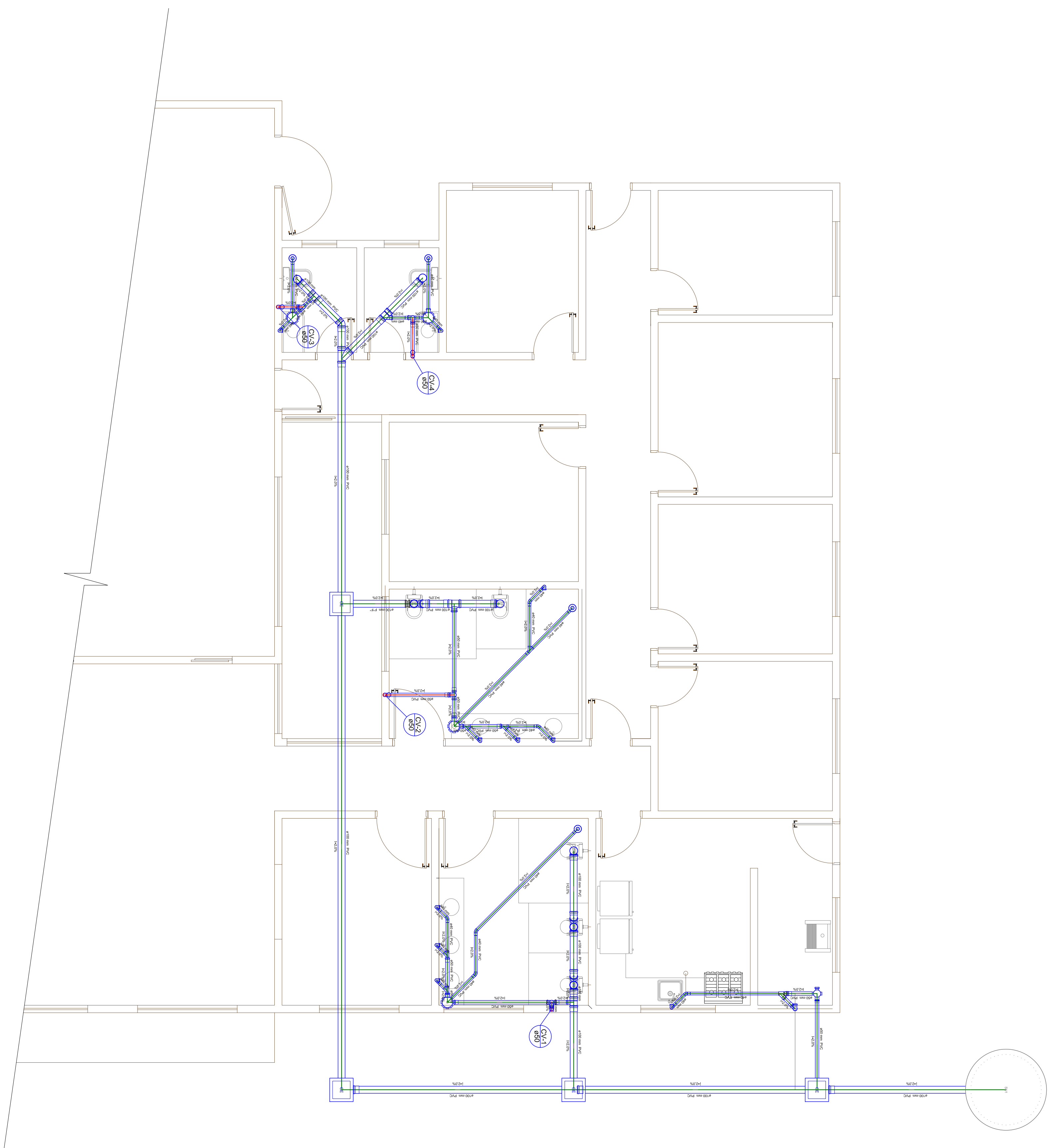
PLANTA ESGOTAMENTO SANITÁRIO ESCALA 1:50
