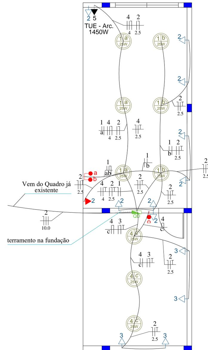
Distribuição dos pontos de iluminação e tomada
