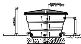
Detalhe Típico - Reservatório Capac. 1000L
