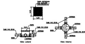
Detalhe-Caixa Múltipla para Inspeção - C.I.
