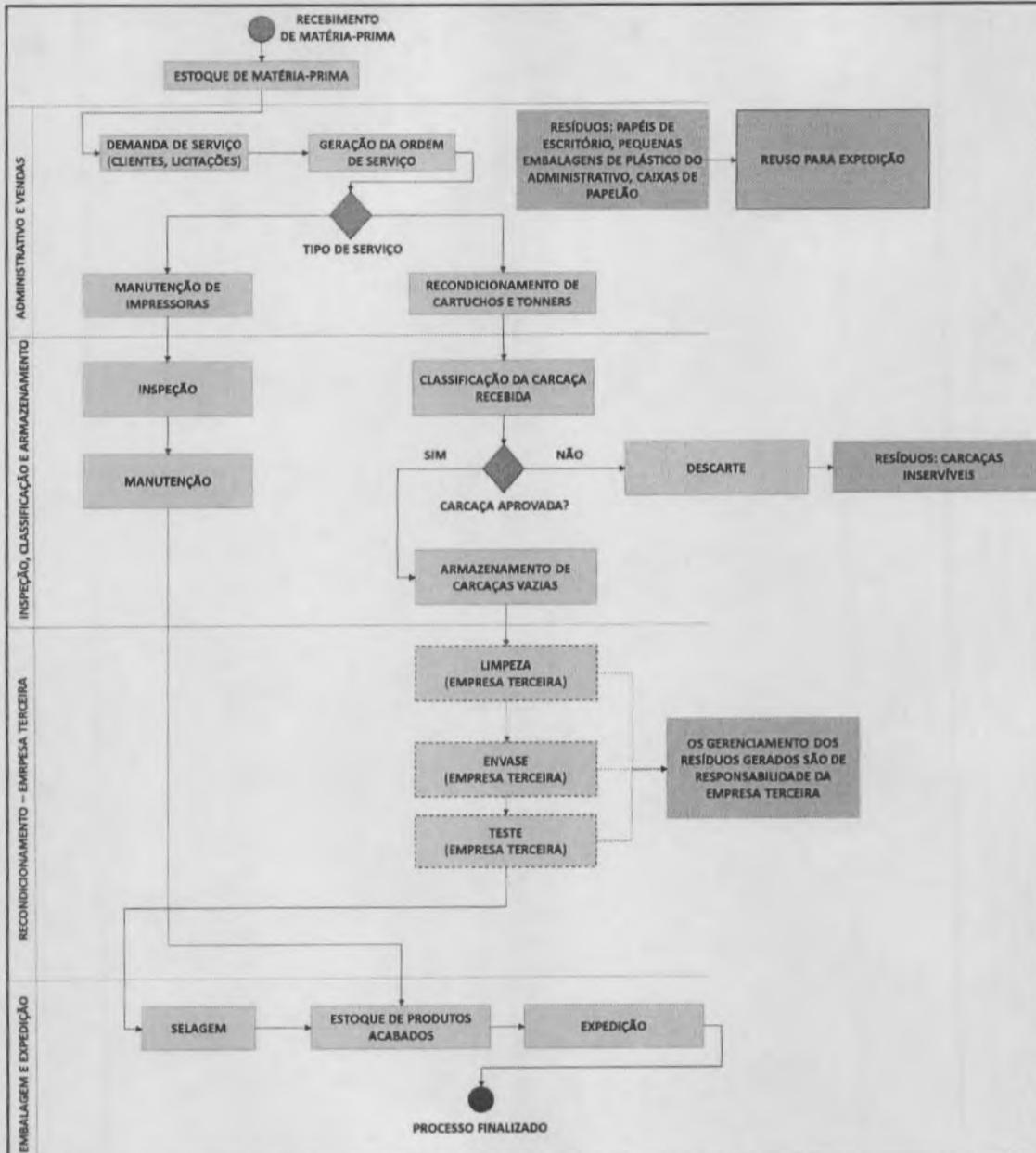
Figura 4: Fluxograma dos processos realizados na empresa.
