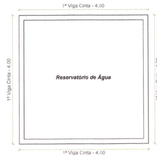
PLANTA BAIXA - 1ª VIGAS CINTAS ESCALA: 1/50
