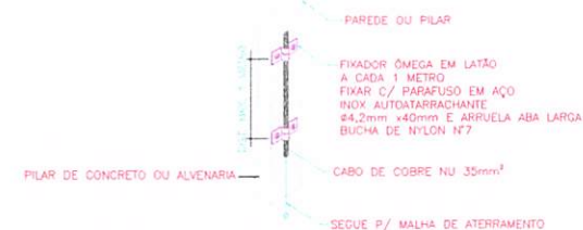
DETALHE C - FIXAÇÃO CABO PRUMADA ESCALA 1:10
