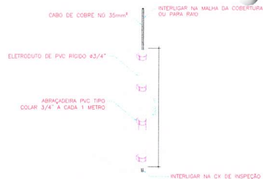
DETALHE B - PROTEÇÃO NAS DESCIDAS SEM ESCALA
