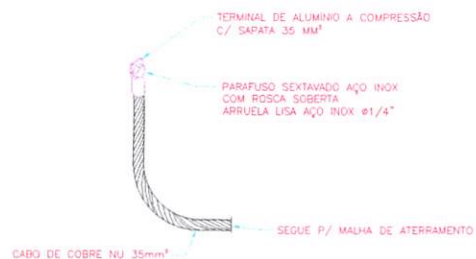
DETALHE D - TERMINAL P/ CABOS ESCALA 1:10
