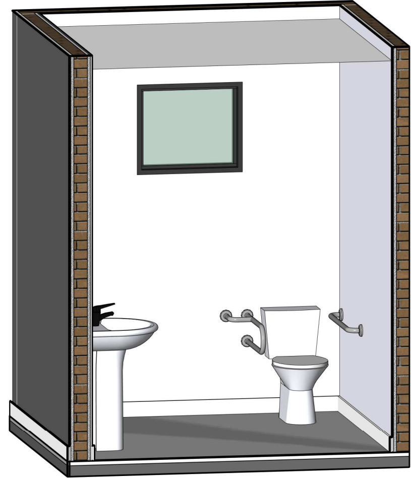
8 Detalhe Banheiro Adaptado ESCALA
